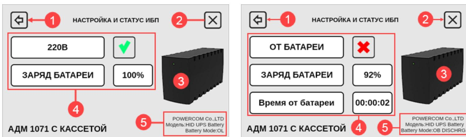
Рисунок 15. Окно тестирования ИБП (А – работа от сети, Б – работа от батареи)
